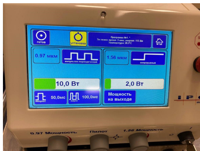
Рис. 2. Двухволновый волоконный лазерный аппарат ЛСП – «ИРЭ-Полус». длина волны 0,97 мкм., мощность - 10 Вт на входе., длина волны 1,56 мкм мощность - 2 Вт на выходе.
