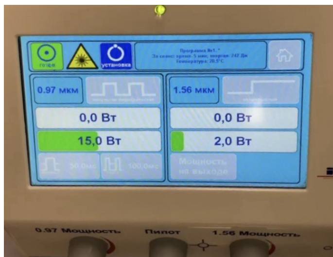
Рис. 4. Двухволновый волоконный лазерный аппарат ЛСП - «ИРЭ-Полус». длина волны 0,97мкм., мощность - 15.0 Вт на входе., длина волны 1.56 мкм мощность - 2 Вт на выходе.
