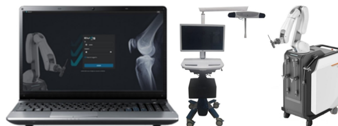
Рисунок 1 - Основные элементы системы CJ150 CUVIS Joint®: а - консоль планирования, б - основная консоль, в - манипулятор
